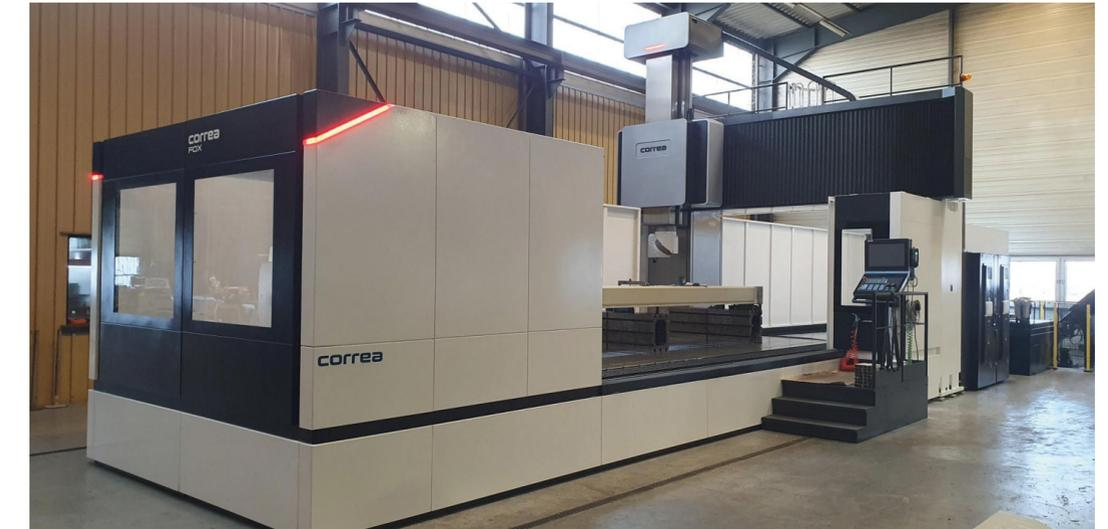
Nouvelle fraiseuse CN 5 axes à portique avec table mobile
