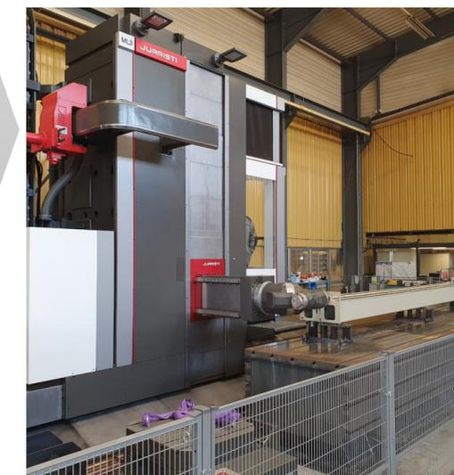
Fraiseuse 5 axes à colonne mobile et banc fixe.
