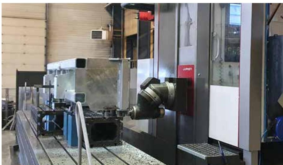
Cette nouvelle fraiseuse 5 axes est à colonne mobile et banc fixe.
